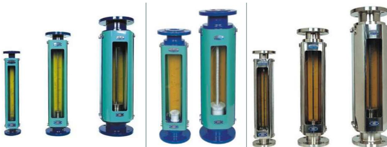
Стекланные ротаметры в металлическом корпусе серии LZB, LZB-F, LZB-B используются для контроля расхода жидкостей или газов. Ротаметры имеют повышенную точность - 1,5%, а также возможностью работы при высоких температурах - до 80°C. Ротаметры имеют фланцевое подсоединение.
