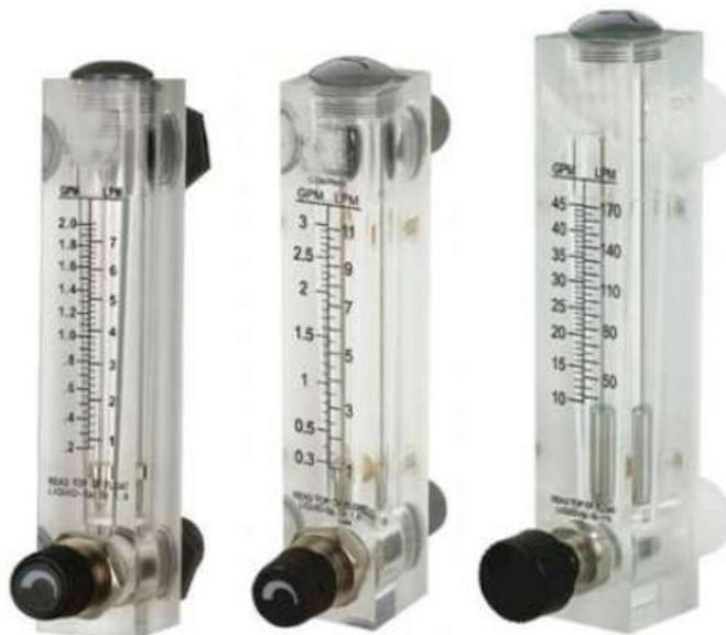
Данный вид ротаметров предназначен для контроля расхода жидкостей и газов в широком диапазоне производительностей. Конструктивной особенностью этого типа является наличие регулировочного вентиля, позволяющего оператору плавно изменять расход воздуха непосредственно на измерительном приборе.
