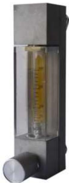
Стеклянные ротаметры серии LZB-DK100 используются для контроля и регулировки чрезвычайно малого расхода газов и жидкостей. Ротаметры имеют точность - 2,5%, а также возможность работы при высоких температурах - до 120°C. Ротаметры серии LZB-DK100 резьбовые. Оригинальный дизайн ротаметра позволяет заменять ротаметрическую стеклянную трубку с поплавком не демантируя прибор из системы. Ротаметры могут быть подключены как к резиновой трубке, так и к металлической трубе.
