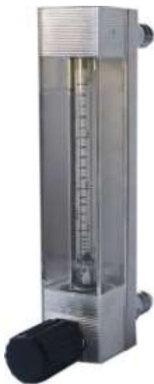
Стеклянные ротаметры серии LZB-DK800 используются для контроля и регулировки чрезвычайно малого расхода газов и жидкостей. Ротаметры имеют точность - 2,5%, а также возможность работы при высоких температурах - до 120°C. Ротаметры серии LZB-DK800 имеют подсоединение штуцера (ёлочка). Оригинальный дизайн ротаметра позволяет заменять ротаметрическую стеклянную трубку с поплавком не демантируя прибор из системы. Ротаметры могут быть подключены как к резиновой трубке, так и к металлической трубке.
